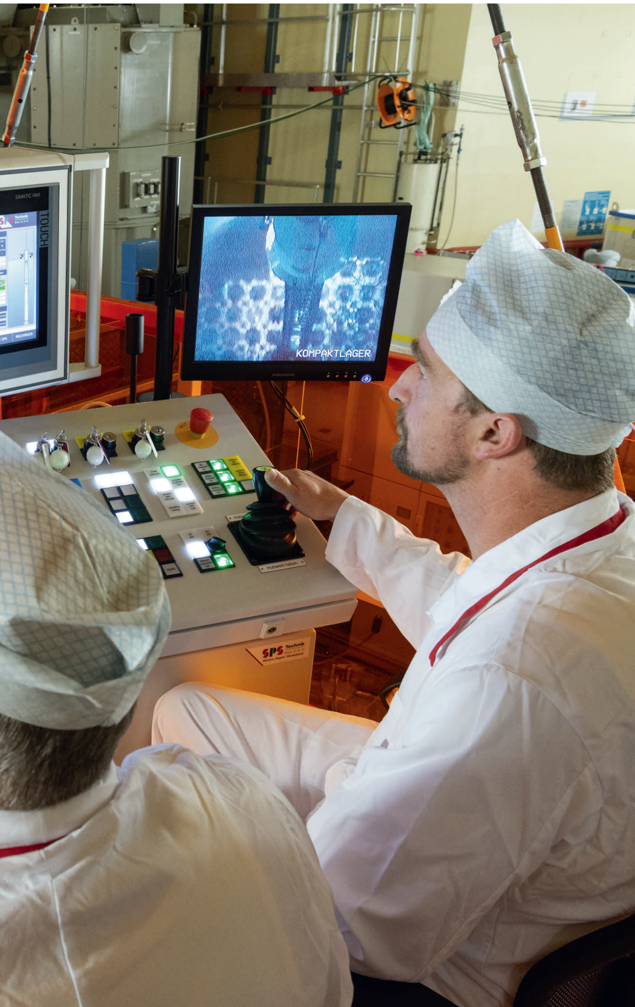
Am Steuerpult Erstmaliges Entladen eines Brennelementes aus dem Reaktor mit der ertüchtigten Lademaschine
