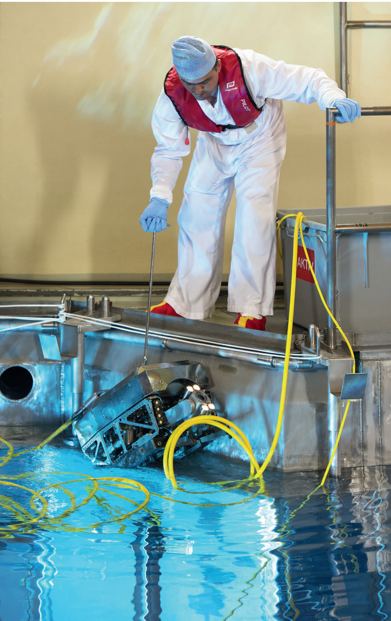
Bergen des fern- gesteuerten U-Boots Zustandskontrolle des Reaktordruckbehälter- unterteils und der Hauptkühlmittelleitungen
