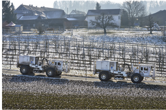
Geologisches Standortgebiet Nördlich Lägern Seismische Messungen mit Vibrationsfahrzeugen
