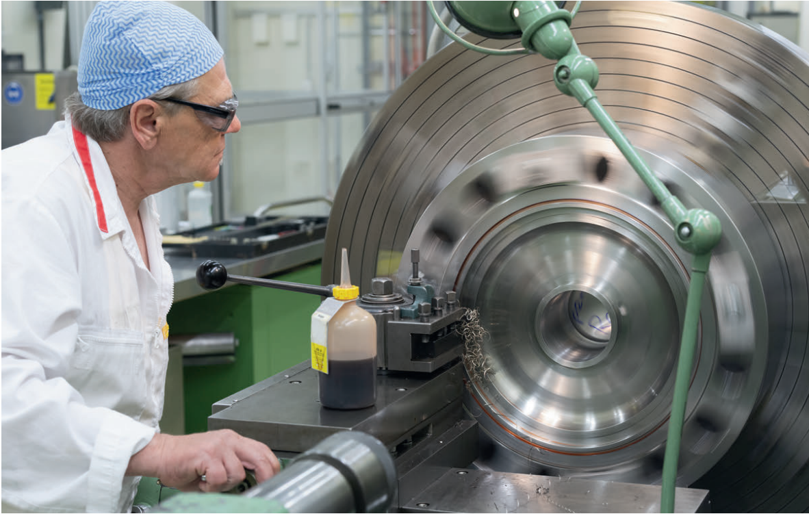
An der Drehmaschine Bearbeitung des Druck- deckels einer Hochdruck- Förderpumpe
