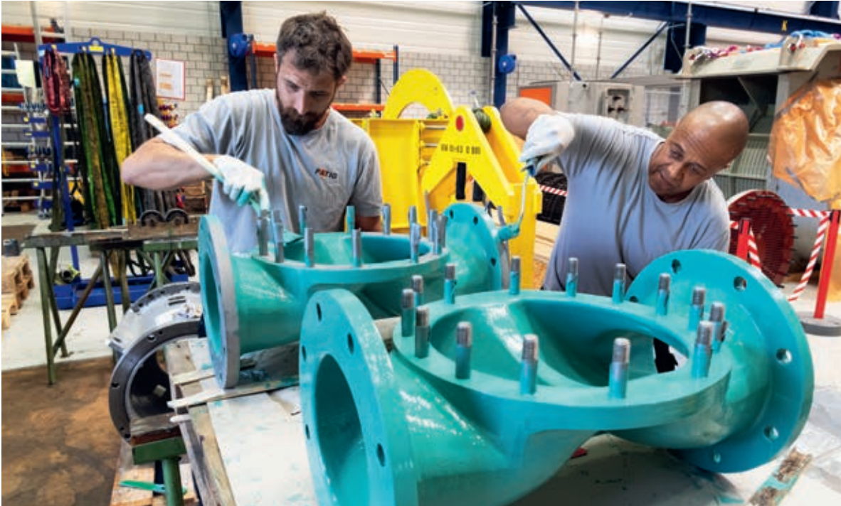
Membranventile aus der Entkarbonisierung Auftragen des Korrosionsschutzes
