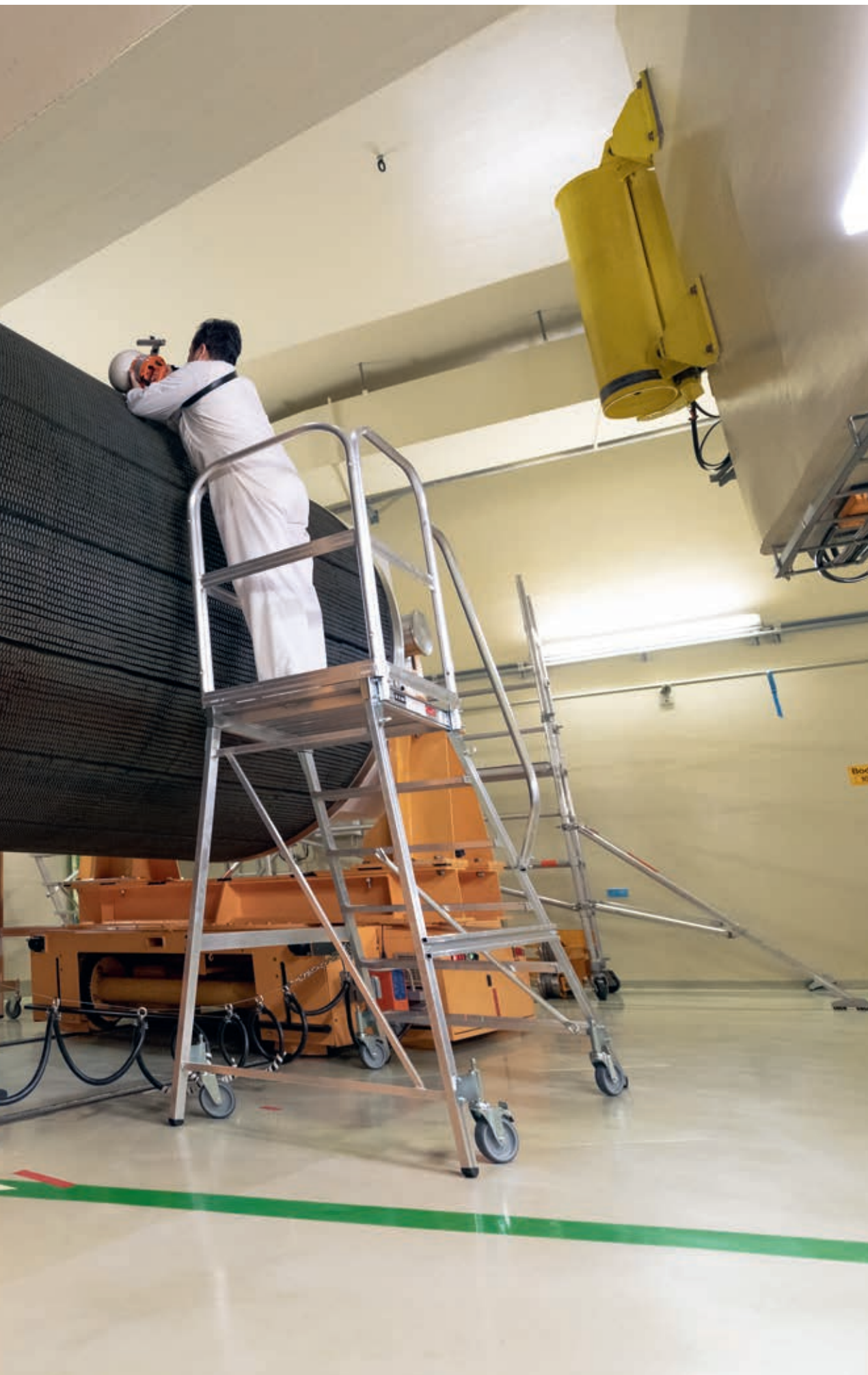
Transportbehälter TN12 Messung der Neutronendosis
