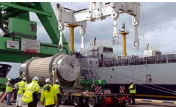
Barrow-in-Furness Handhabungstests mit einem leeren Transport- und Lagerbehälter für hochaktive Abfälle.
