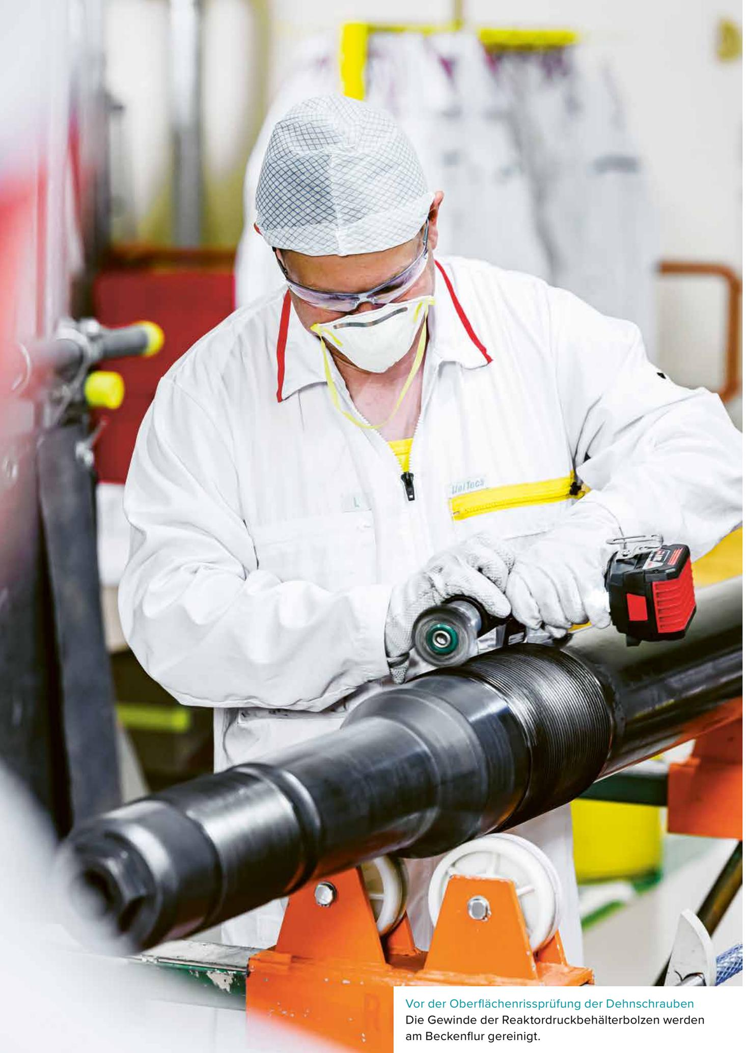
Vor der Oberflächenrissprüfung der Dehnschrauben
