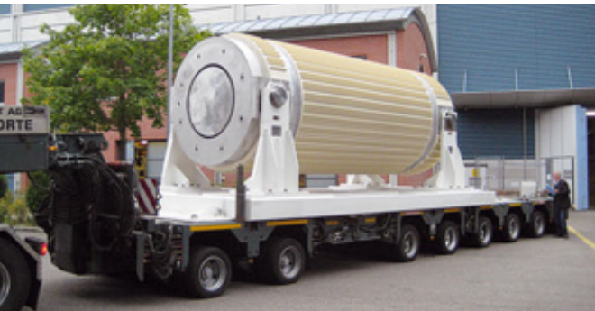
Vor dem Zwiilag Zufahrt eines TN81-Transportbehälters
