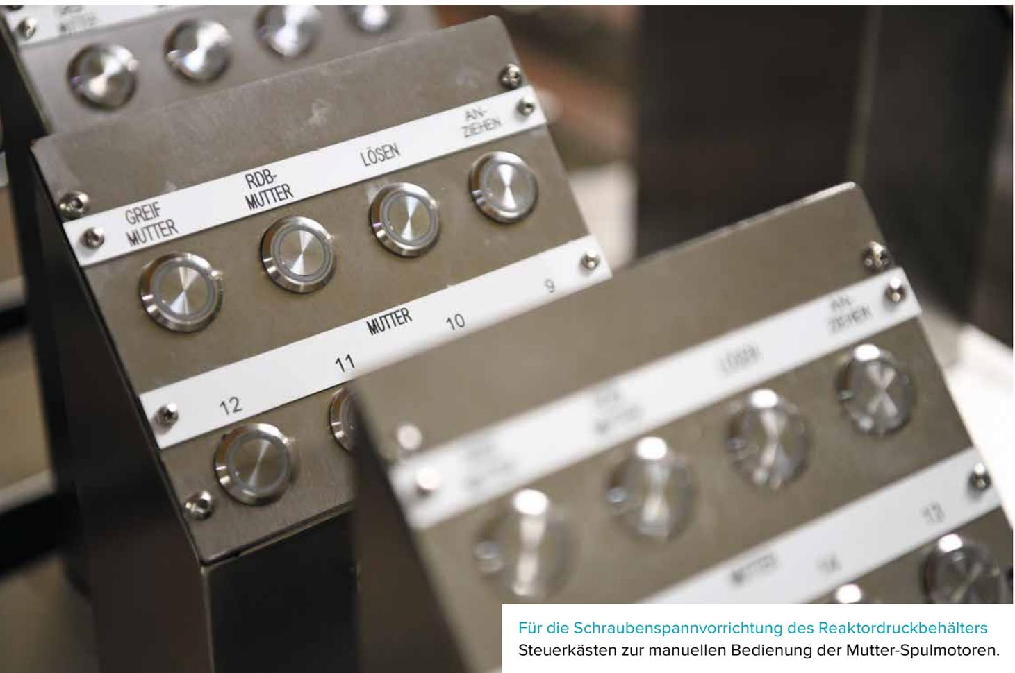
Für die Schraubenspannvorrichtung des Reaktordruckbehälters
