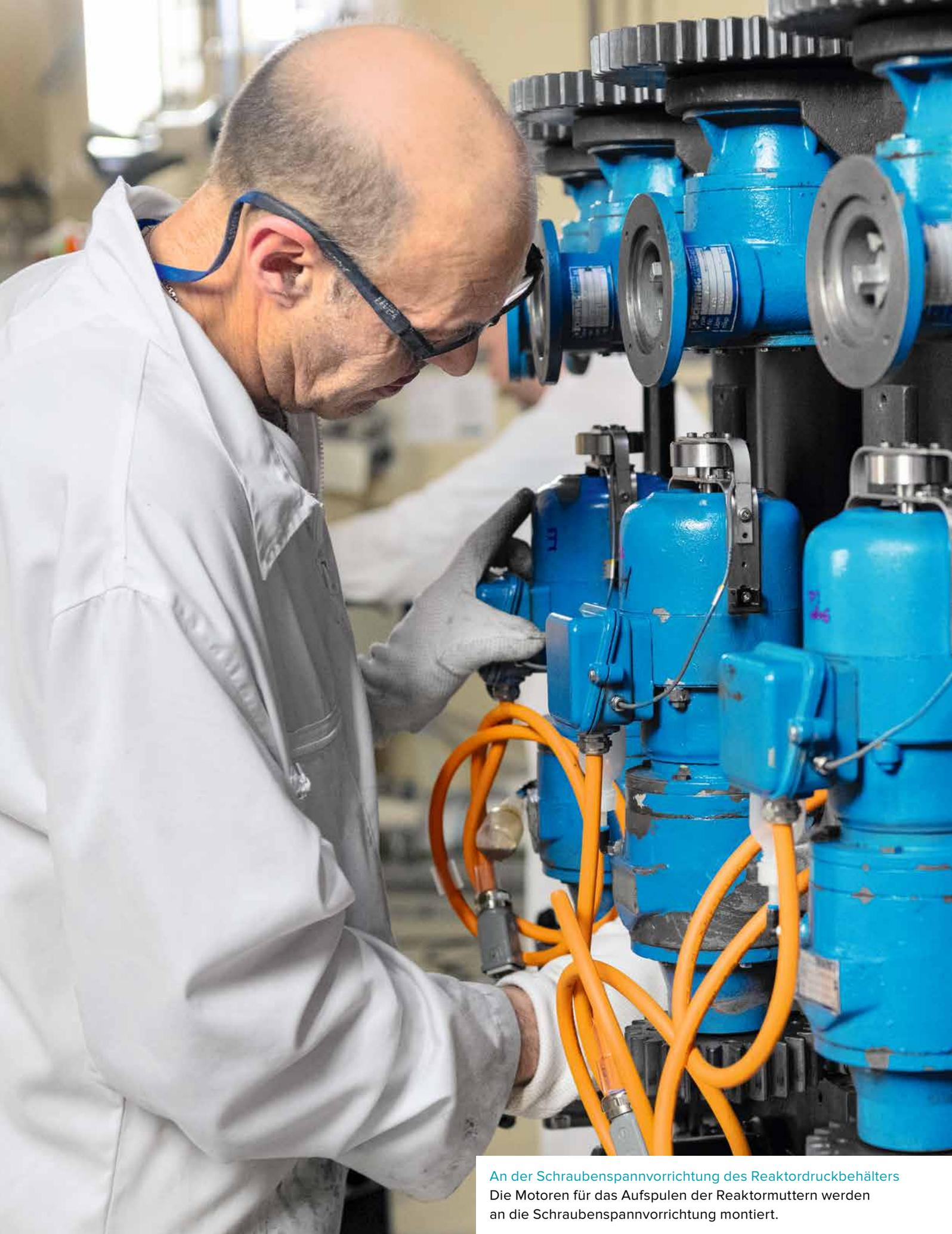
An der Schraubenspannvorrichtung des Reaktordruckbehälters
