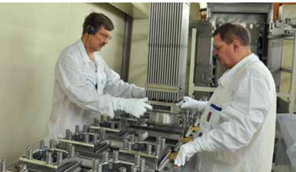
Trockenlager Die Brennelemente werden der Eingangskontrolle unterzogen.
