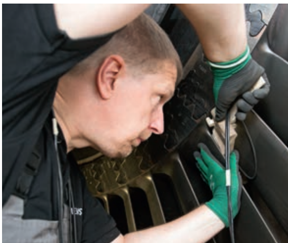
An den Niederdruckturbinen Ultraschallprüfung der Endschaufeln
