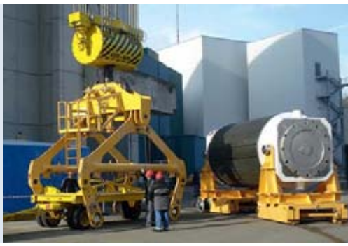
Transfer von ausgedienten Brennelementen vom Reaktorgebäude ins Nasslager
