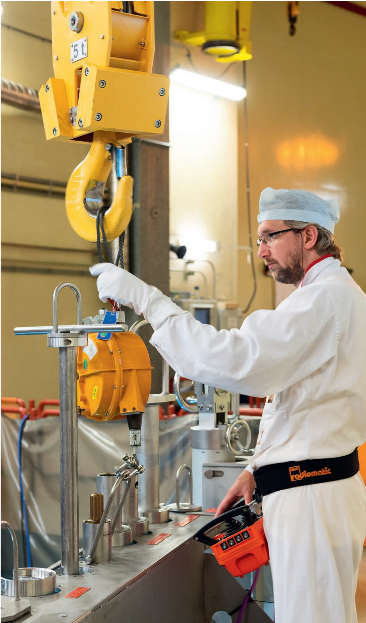
Beim Ladebecken Umsetzen von Materialteststäben
