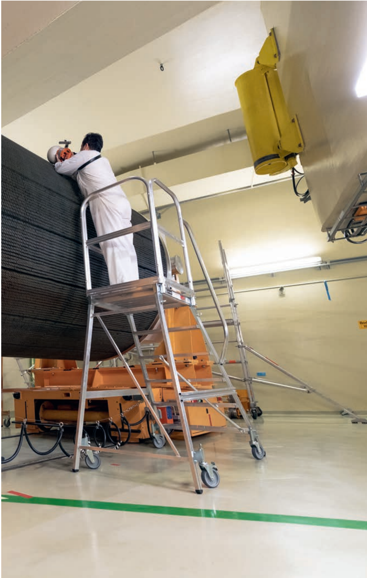
Transportbehälter TN12 Messung der Neutronendosis
